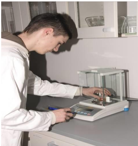
Slika 1: Tehtanje na analizni tehtnici (Vir: lasten, 2009)
